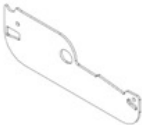
L03 LOUVER SIDE PLATE - A4M02334 (x46) 1/16"x2 3/16"x6 9/16" (2x55x167)
