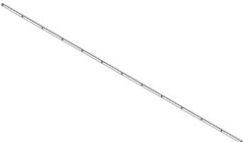
F02 LOUVER TIE STRAP - A4M02130 (x4) 1/8"x13/16"x81 9/16" (3x20x2072)
