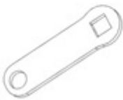
F04 LINKAGE STRAP - A4M02225 (x1) 1/8"x13/16"x2 5/8" (3x20x66)
